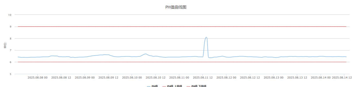
图 5.4-1 污水厂总排放口外排 pH 曲线
