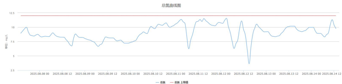
图 5.4-4 污水厂总排放口外排总磷浓度曲线
