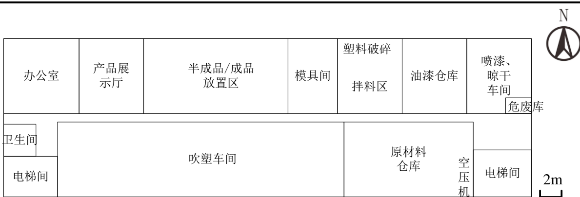
图 2-1 项目车间平面布置示意图
